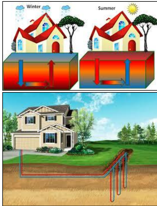
شكل رقم (10) استخدام الحرارة الأرضية ( صيفاً وشتاءً ) في تزويد المناطق السكنية بالطاقة الحرارية اللازمة لها. المصدر: [14]
