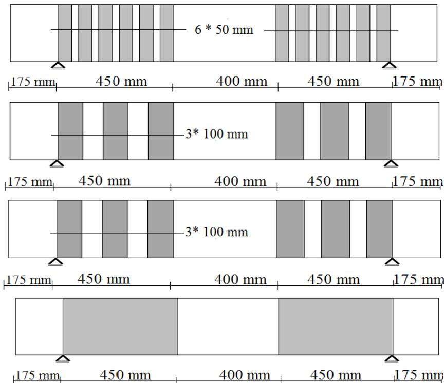
**Fig. 6:** CFRP wrapping schemes
