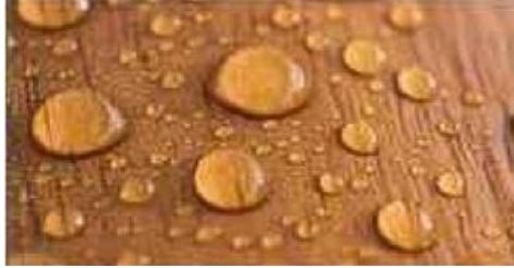
شكل (4) سطح الخشب المعالج بطلاء من طلاء النانو الطارد للمياه. المصدر http://lotusanotech.com/our_products.html
