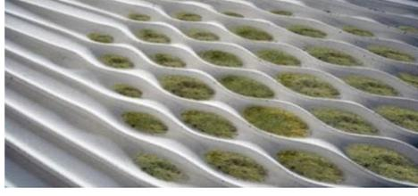
هو نوع من الخرسانة التي تدعم نمو الطحالب الصغيرة والفطريات. وتتكون هذه المادة المتعددة الطبقات من نوعين من الأسمنت: الأسمنت البورتلاندي القياسي وأسمنت الفوسفات الماغنسيوم وبالتالي يؤدي إلى النمو البيولوجي. يتم تغليف هذه المواد بطبقة إضافية لإنشاء لوحا عموديا لواجهات المباني وتشمل: طبقة مضادة للماء تحمي الخرسانة من التلف وهي طبقة طلاء عكسي للماء لتسهيل عملية جمع وتخزين مياه الأمطار في الطبقة العضوية (21).
